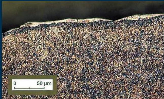
用铜电极进行电火花加工后的表面
